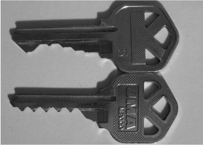
Figura 9.2 Una chiave standard (in alto) e una bump (in basso). Notate i denti corti e di altezza uniforme sulla bump key.
