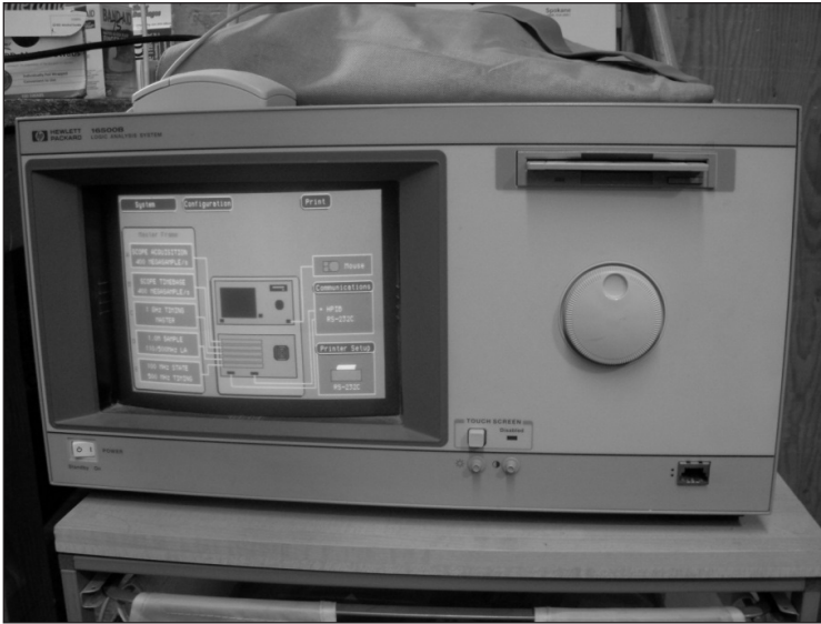
Figura 9.15 Un analizzatore logico visualizza i segnali che attraversano un bus.
