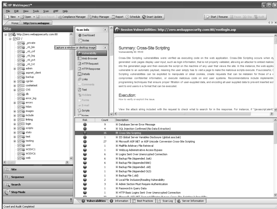
Figura 10.10 HP WebInspect, strumento per scansioni di sicurezza su applicazioni web, analizza il sito di esempio, zero.webappsecurity.com.
