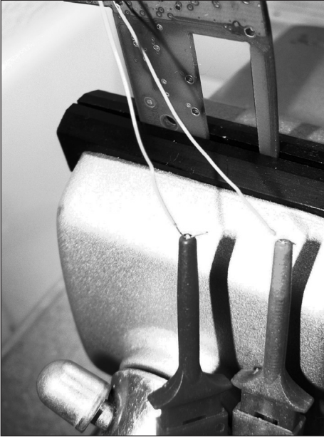
Figura 9.18 Un PCB con dei fili che costituiscono punti di test per l'analizzatore logico.
