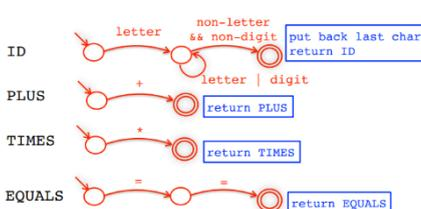
o Questa **azione riporta il lexer allo stato iniziale** (in realtà il lexer viene invocato dal parser, ogni volta che viene restituito esattamente un token)
